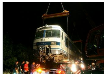
420 002 hängt an den beiden Kränen und wird gleich auf den Tieflader abgesetzt. Foto: G. Schweitzer
