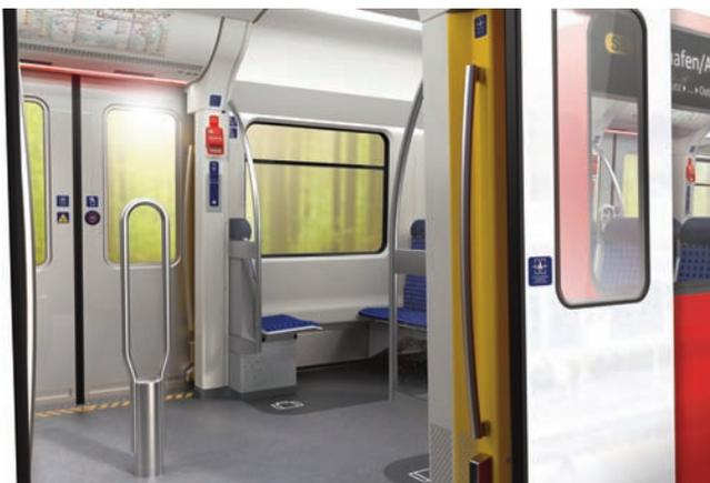
Für mehr Sicherheit sorgen Haltepilze im Einstiegsbereich und verbesserte Festhaltungsmöglichkeiten an den Sitzen. Der transparent gestaltete, vollständig einsehbare Fahrzeuginnenraum und der Einsatz moderner LED-lichttechnik verbessern das Sicherheitsgefühl merklich.
