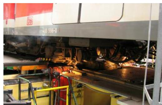
Auf der UFD (Unterflurdrehbank) werden gerade bei 423 098 die Radreifen abgedreht. Foto: A.Hauptmann
